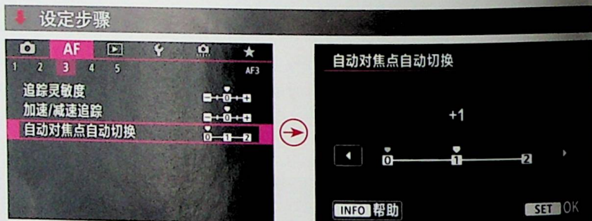
① 在自动对焦菜单3中选择自动对焦点自动切换选项
