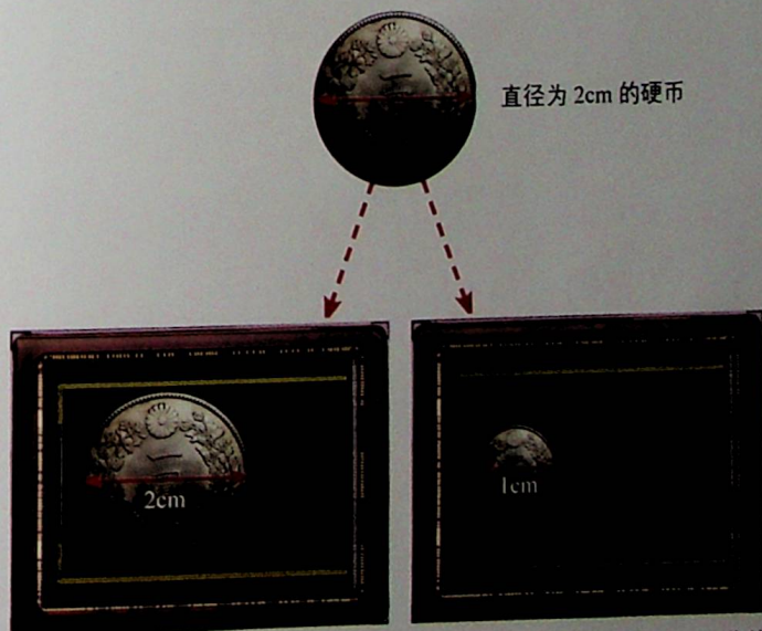
▲ 使用最大放大倍率约为 1 倍的镜头将其拍摄到最大,在图像感应器上的成像直径为 2cm
