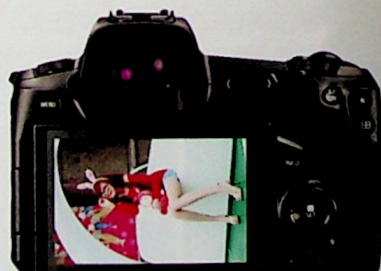
▲ 选择第 2 个和第 3 个选项时，浏览照片时竖拍照片仍然保持拍摄时的方向
