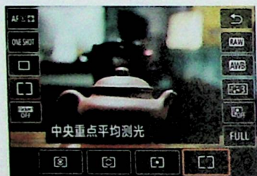
▲ 选择中央重点平均测光模式时的速控屏幕
