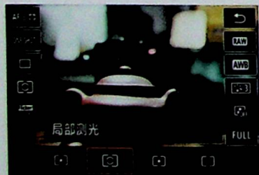
▲ 选择局部测光模式时的速控屏幕
