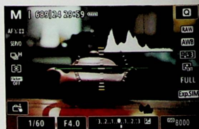
序号 3 在显示完整拍摄信息的基础上，再增加显示柱状图和数字水平量规，以确定照片是否曝光合适，以及确认相机是否处于水平状态
